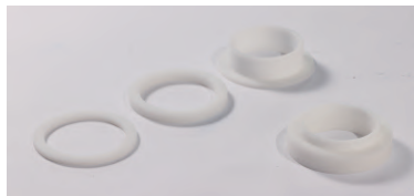
ハイトアジャスターはエアロパーツ装着車などの車高調整用。スプリング単体で車高は約30mmダウン。スパーサー式で10mmから25mmダウンまで5mm単位で補正できる
