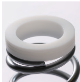
ハイトアジャスターはエアロパーツ装着車などの車高調整用。スプリング単体で車高は約30mmダウン。スパーサー式で10mmから25mmダウンまで5mm単位で補正できる
