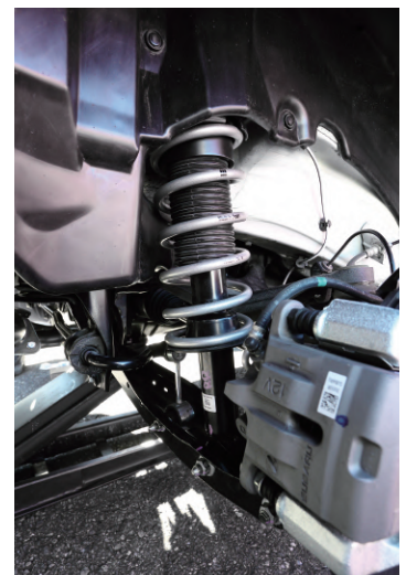
ダウンサスの類でも密巻き部分を持つ可変レートではなく、純粋なシングルレート
