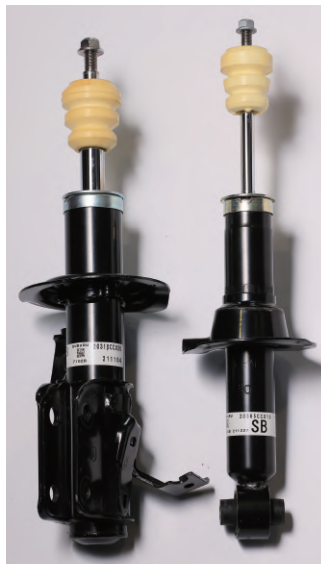
純正ダンパーは複筒式で、フロントはリバウンドスプリングを内蔵する
