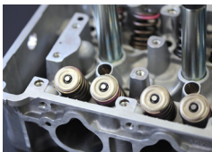
バルブスプリング組み付け
