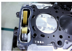
ヘッド、ブロック組み付け
