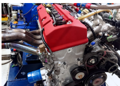
エンジンベンチテスト (動作確認・初期ならし / パワー チェック)
