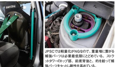
JPSCでは軽量化がNGなので、重量増に繋がる補強パーツは必要最低限にとどめている。ストラットタワーのトップ部、前席背後と、的を絞って補強パーツをセットし剛性を高めている。
