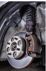
前後とも倒立式の高車高調。リアダンパーは立て気味になるよう、取り付け方法を見直している。フロントブレーキはMR-S用キャリパー&ローター。ヴァイツRS用を利用する手法もあるそうだ。
