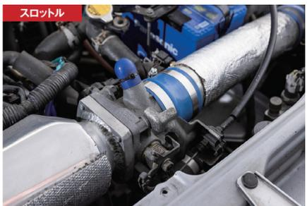
スロットルはセラカ用（2ZZエンジン）だが、実は以前も1ZZエンジン用を使用していた。現在、純正比で10mm以上大径仕様となっている。
