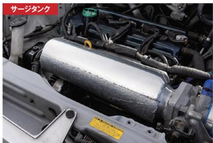
ワンオフ製作したサージタンクが存在感抜群！この中には、4連ファンネルが搭載されている。走行風を積極的に取り込む工夫も盛り込んでいる。
